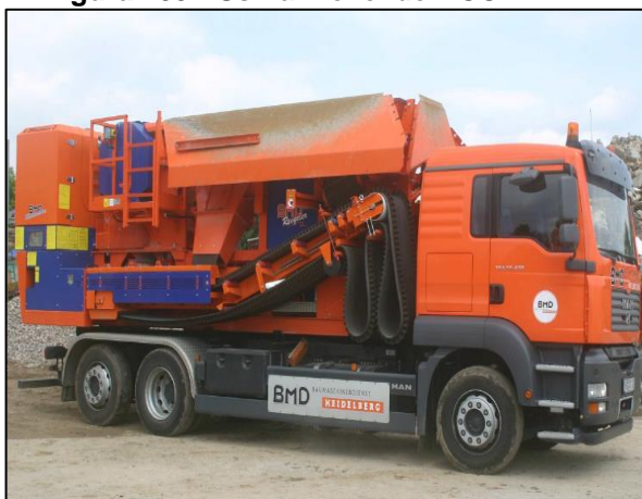
Figura 105 - Usina móvel de RCC.
