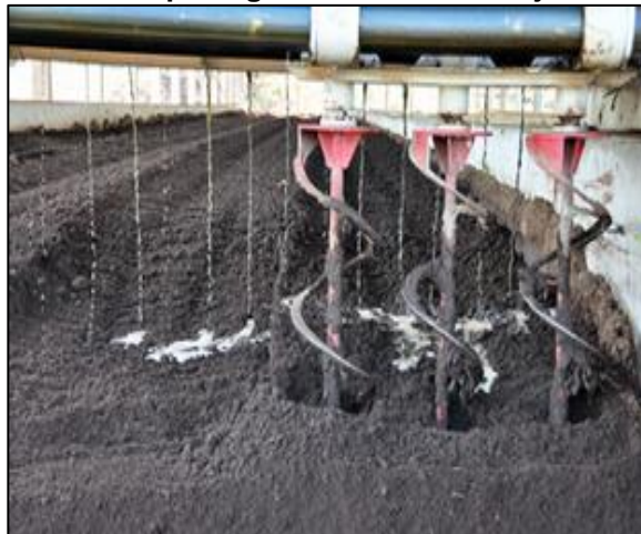
Figura 99 - Compostagem mecânica de dejetos suínos.
