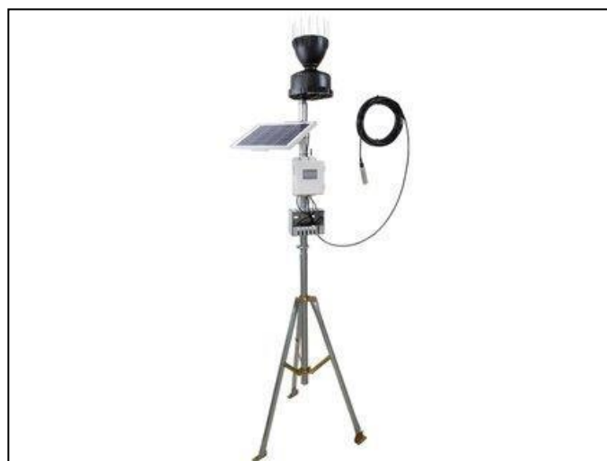
Figura 128- Estação Fluviométrica Automática.
