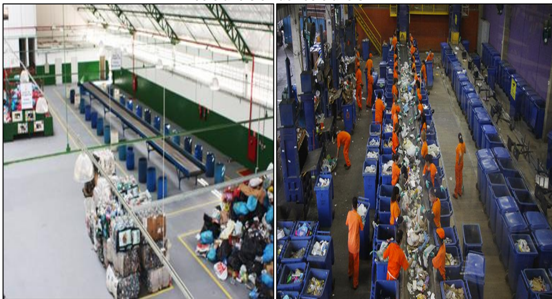
Figura 96 - Centro de Triagem de Resíduos Sólidos - CTRS e segregação de resíduos recicláveis e não recicláveis.
