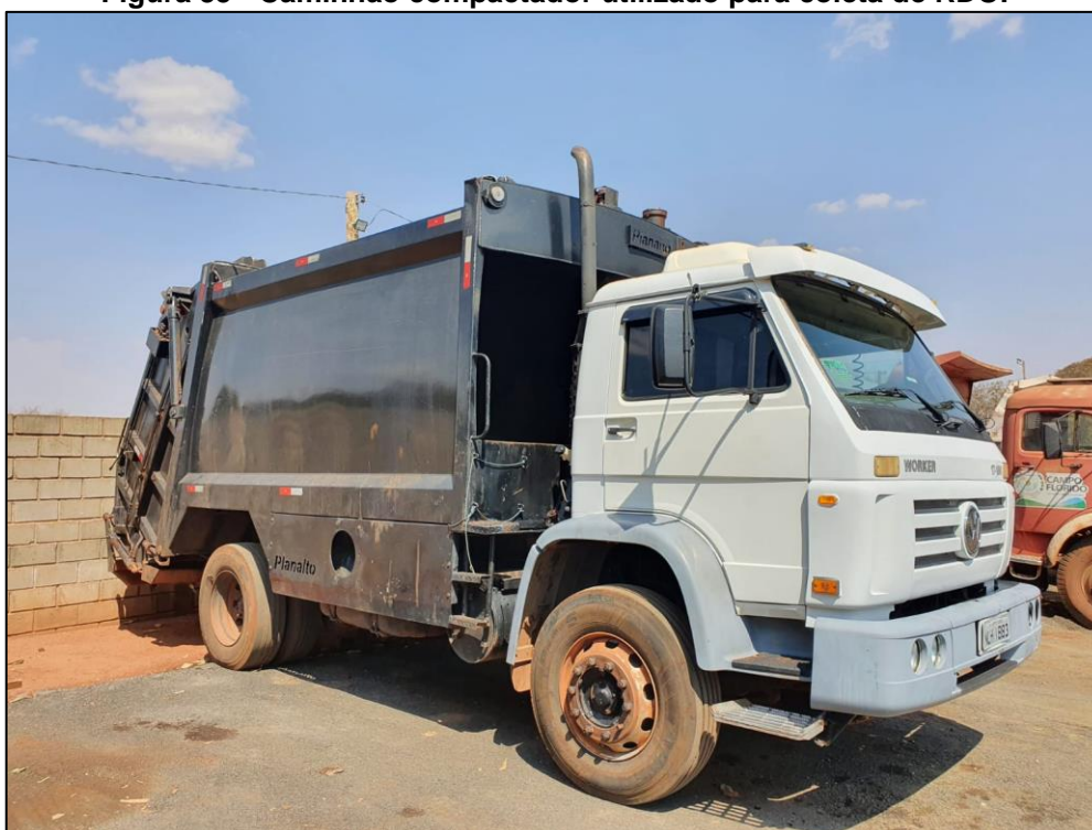
Figura 35 - Caminhão compactador utilizado para coleta de RDO.
