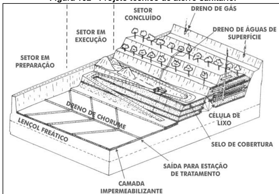
Figura 102 - Projeto técnico de aterro sanitário.
